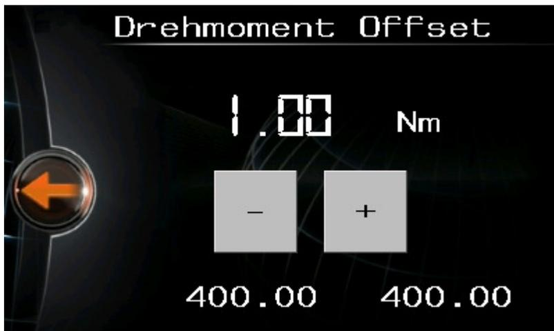
Unter den – und + Buttons sehen Sie links das aktuell gemessene maximale Drehmoment aus der Motorelektronik. Rechts daneben sehen Sie live den veränderten Wert durch den Drehmoment Offset.
