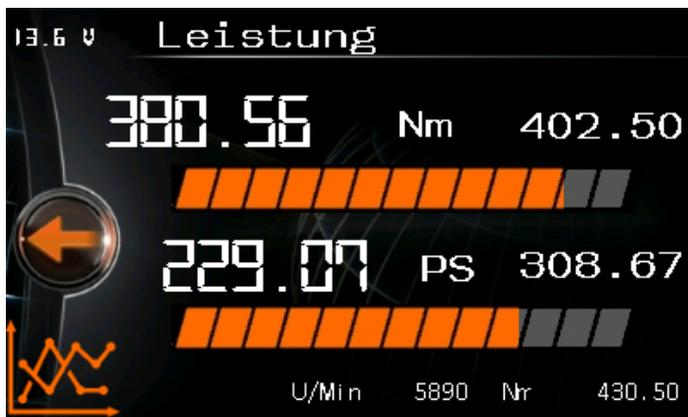
Durch drücken auf die Maximalwerte (rechts) können die Werte einzeln zurück gesetzt werden.
