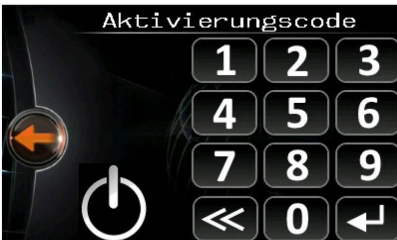
Durch Drücken der Taste „Aktivieren“ wird der Code überprüft und der Status des Displays wird auf aktiv bzw. Inaktiv gesetzt.
