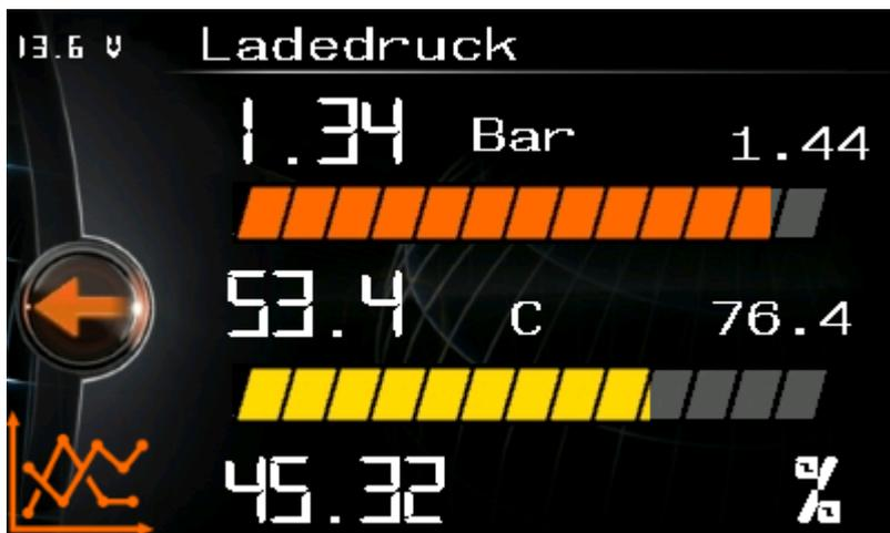
Visualisiert werden dabei: Ladedruck IST/MAX und Ansauglufttemperatur (IAT) IST/MAX Numerisch sowie eine Balkenansicht des Istwertes.
